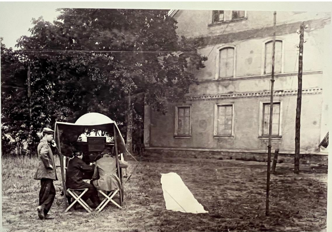
Mobile Funk- und Fernmeldestation der Nachrichtentruppe zur Nachrichtenübermittlung zwischen Flugzeug und Artilleriestellung.
